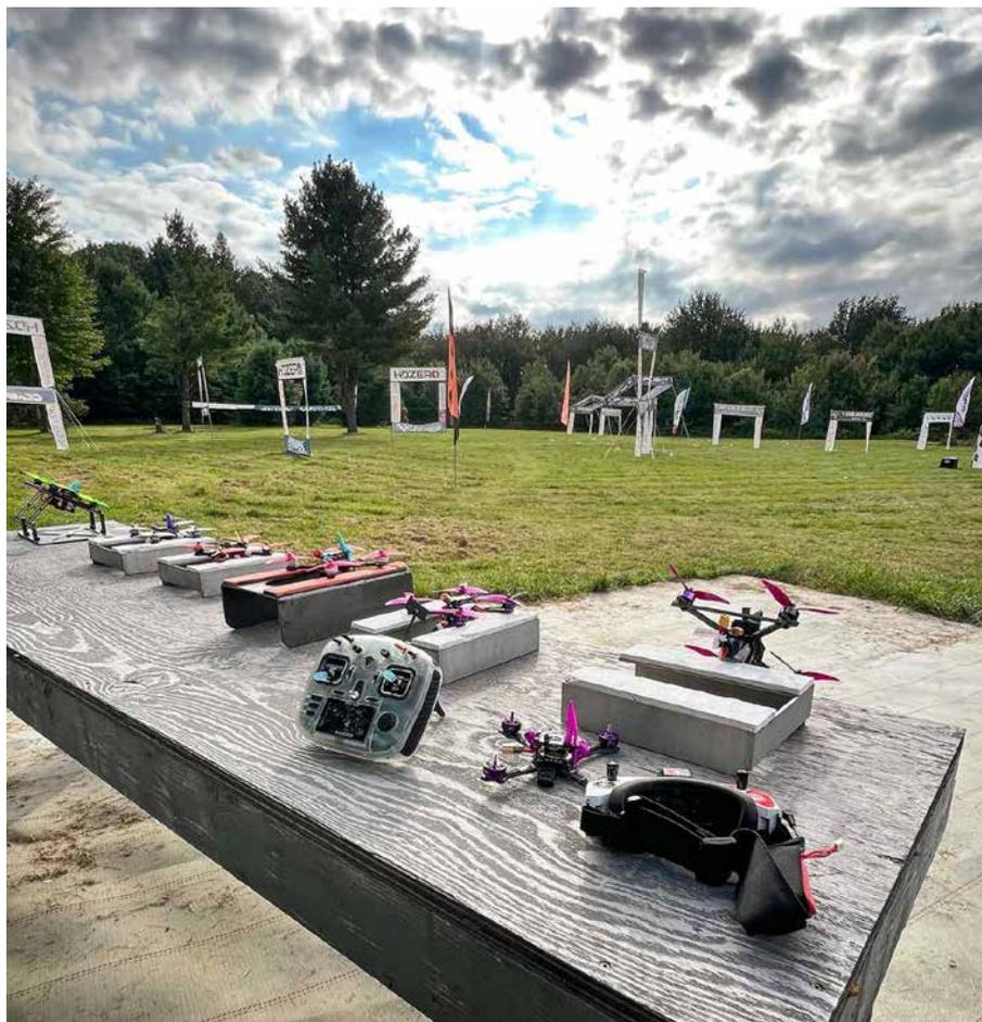
plus restrictive. Les drones doivent peser au moins 1 280 grammes, utiliser des hélices de 7 pouces – Gemfan les a fournies à titre gracieux – des batteries Li-Po 5S de 2 200 mAh, des moteurs 2808 ou plus petits, et doivent utiliser une version spéciale du micrologiciel (firmware) de contrôleur de vol Betaflight afin de contrôler et de limiter les tours-minute des moteurs.
